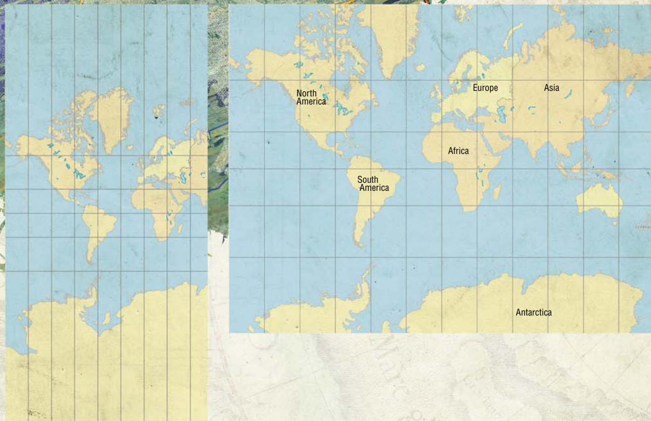
Карта мира в проекции Меркатора. Приполярные области сильно растянуты из-за увеличения масштаба (слева), поэтому карты в этой проекции обычно ограничивают 80-й параллелью (справа)
